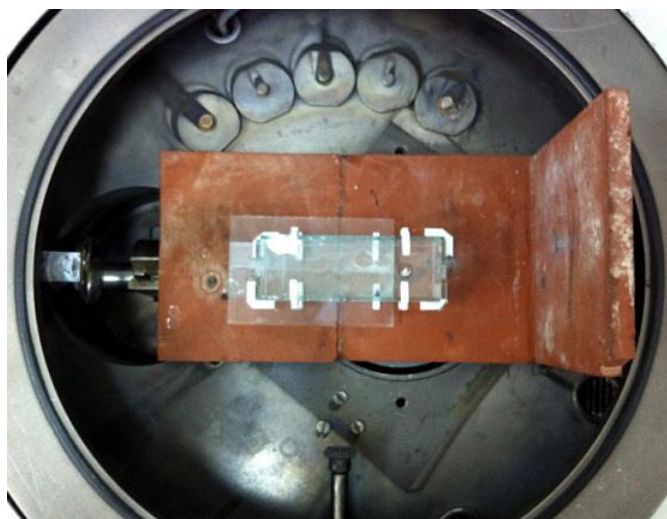
Рис. 3. Механизм позиционирования лазерной мишени
