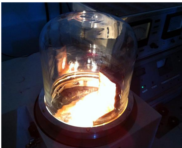
Рис. 1. Рабочая область вакуумного универсального поста (ВУП-4) в ходе процесса
