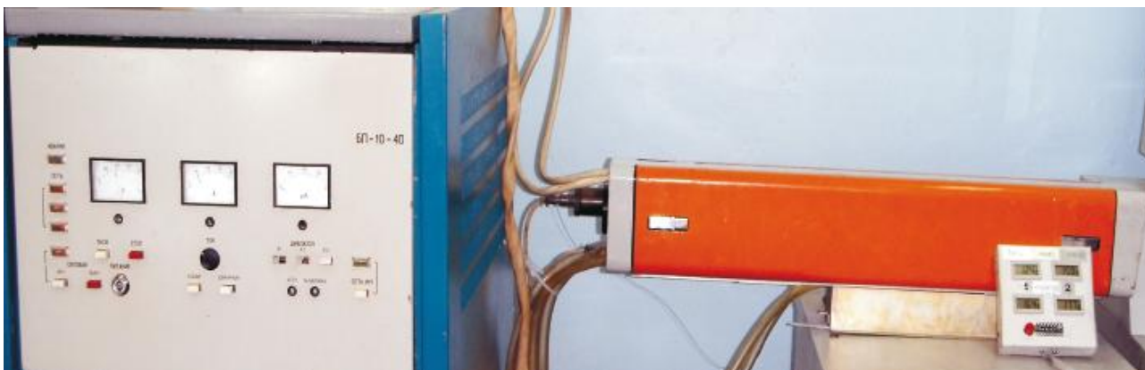
Рис. 2. Неодимовый лазер (слева приборная панель блока управления)
